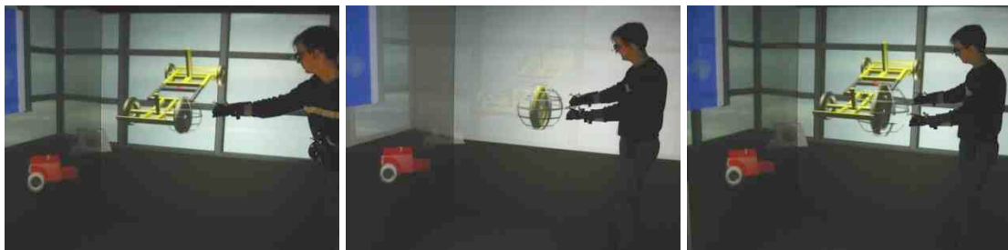
Abbildung 2: Zweihändige Skalierung eines Bauteiles in der Virtuellen Werkstatt.
