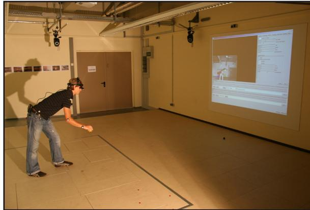
Abb.1: Augmented Reality im Bewegungenlernen: Untersuchungs-Set-up mit See-Through-Display; High-Speed-Infrarotkameras (VICON), High-Speed-Videokamera (Basler), Kraftmessplatten (AMTI) im Bielefelder Biomechaniklabor.
