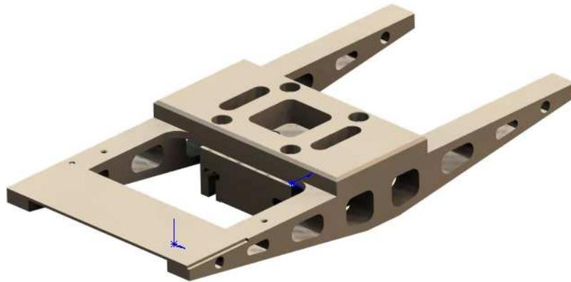
**Abbildung A.2:** Der letztendlich zum Einsatz gekommene Objektträgerhalter zusammen mit dem piezoelektrischen Aktuator unterhalb des Trägers: die Konstruktion ist einerseits vollkommen symmetrisch konzipiert, um zusätzliche Gradienten auf den Piezo zu vermeiden und weist andererseits sehr viele Hohlräume auf, wodurch das auf dem Piezo lastende Gewicht auf ein Minimum reduziert werden konnte.
