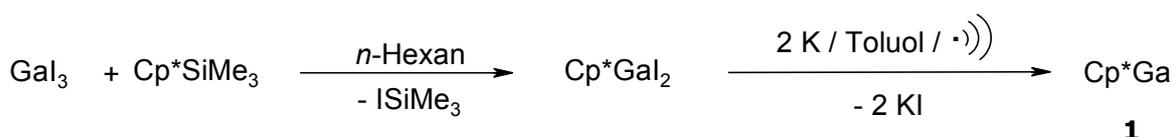
**Abb. 1.5:** Synthese von  $Cp^*Ga$  **1** durch reduktive Dehalogenierung von  $Cp^*GaI_2$ .
