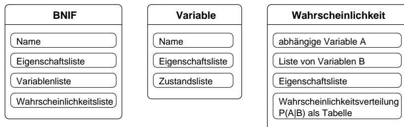
Abb. 8.1: Objekte zur Repräsentation von Bayes-Netzen analog zum BNIF-Format.
