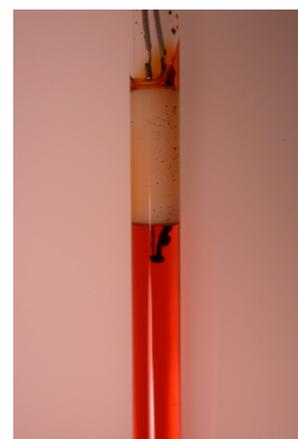
**Abb. 2.22:** Ein Einkristall von [**2f** · 1.5 Pyrazin · 1.5 Toluol] zwischen zwei Platinelektroden
