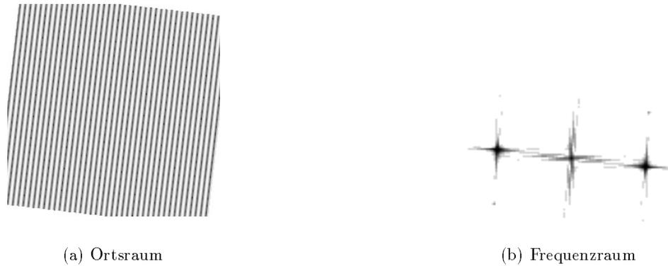
Abbildung 14: Zur Wirkung der Fouriertransformation, Streifenbild um  $6,6^\circ$  gedreht
