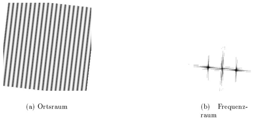
Abbildung 15: Zur Wirkung der Fouriertransformation, Streifenbild um  $6,6^\circ$  gedreht,  $\times 2$
