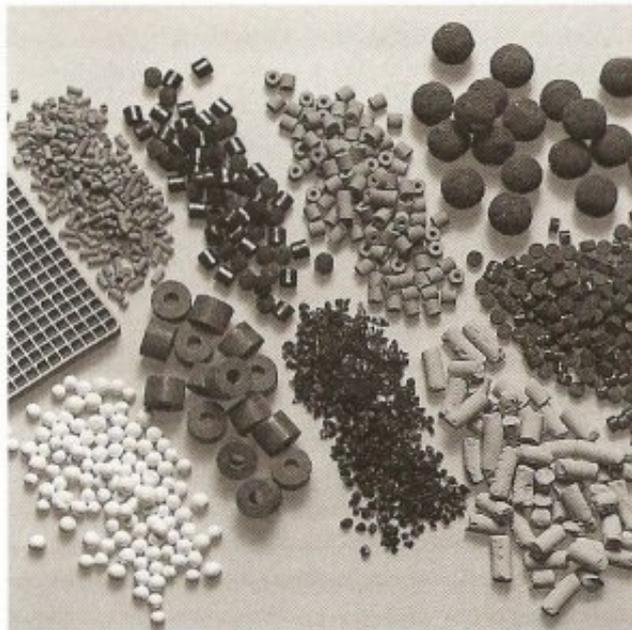
**Abbildung 39:** Verschiedene Katalysatorformkörper (BASF AG Ludwigshafen)<sup>[18]</sup>.
