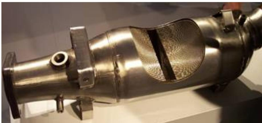
**Abbildung 24:** Handelsüblicher, aufgeschnittener Edelmetallkatalysator eines Fahrzeugs<sup>[96;97]</sup>.
