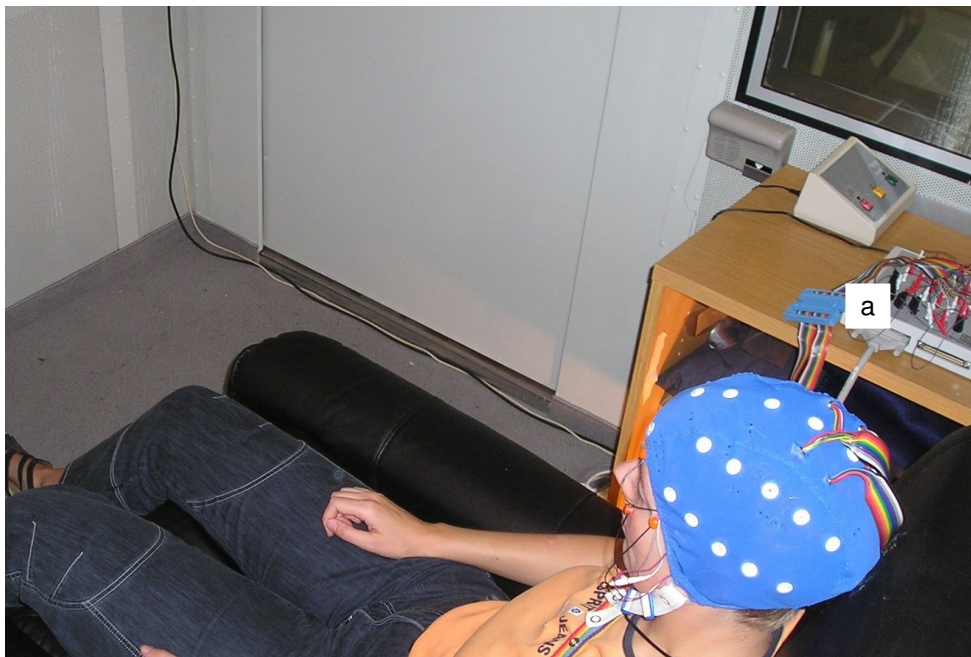
Abb. 20: Geräte für die EEG-Aufnahme: Jackbox (a)
