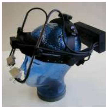
Abbildung 6.3: SMI EyeLink binokularer Eyetracker.
