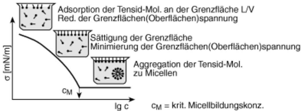
Abbildung 1.6: Konzentrationsabhängigkeit von der Oberflächenspannung c(\sigma) [Rö04]. Die Grenzfläche L/V besteht zwischen der Flüssigkeit (engl.: liquid phase, Abk.: L) und Luft (engl.: vapor phase, Abk.: V).
