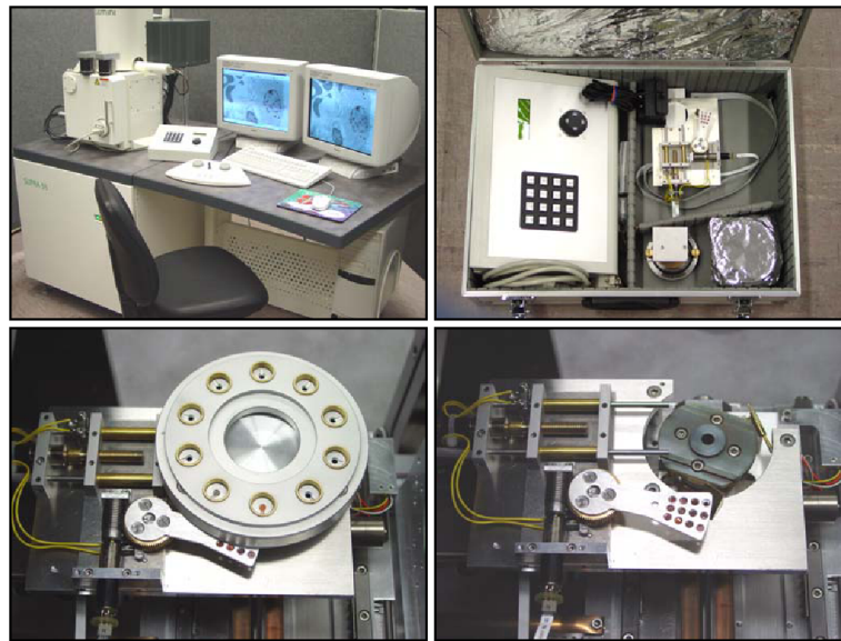
Abbildung 6.15: In den obigen Bildern ist das STEM-Typ I-Zubehör zu erkennen, das entweder in den Arbeitsplatz des Rasterelektronenmikroskopes integriert ist (links) oder kompakt und platz sparend in einem Koffer aufbewahrt werden kann (rechts) [GS]. Vom Equipment ist der Probenhalter (Aufsicht unten links), die Blendenzunge (unverdeckt, unten rechts), der Probenstisch mit Konversionsstübchen und die Ansteuerung für die verschiedenen Blenden mit Tastaturbelegung und 4-Quadranten Kippschalter (jeweils oben rechts) zu sehen.
