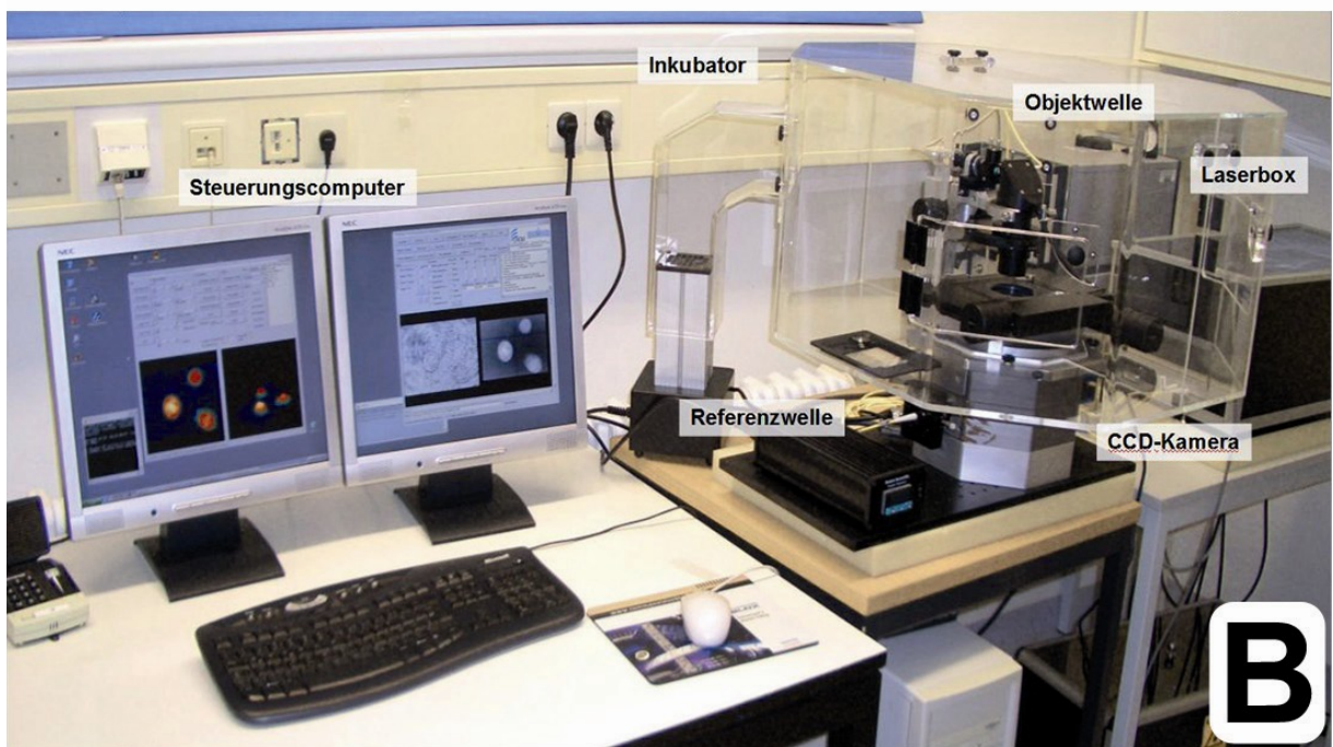
Abbildung 4: A: Schematische Darstellung des Lichtweges in der DHM. B: Messaufbau des DHM am Centrum für Biomedizinische Optik und Photonik in Münster.
