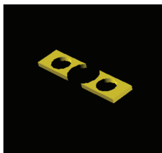
Abbildung 68: Fehlerhafter Skalierungswert eines Loches in einer Dreilochleiste
