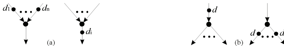
Abbildung 2: Vereinigende (a) und replizierende (b) Verbindungen (Joint / Replica links) – aus (Verdoscia & Vaccaro, 1998)
