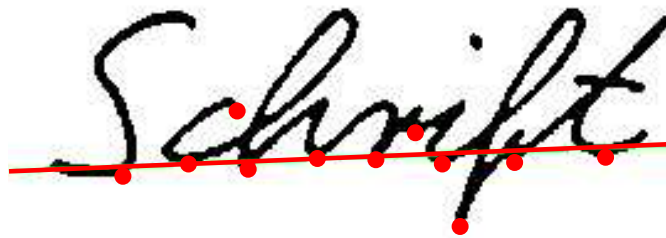
Abbildung 3.10: Approximation einer Geraden an die Schriftgrundlinie. Die Punkte stellen die verwendeten lokalen Minima der Schriftkontur dar.
