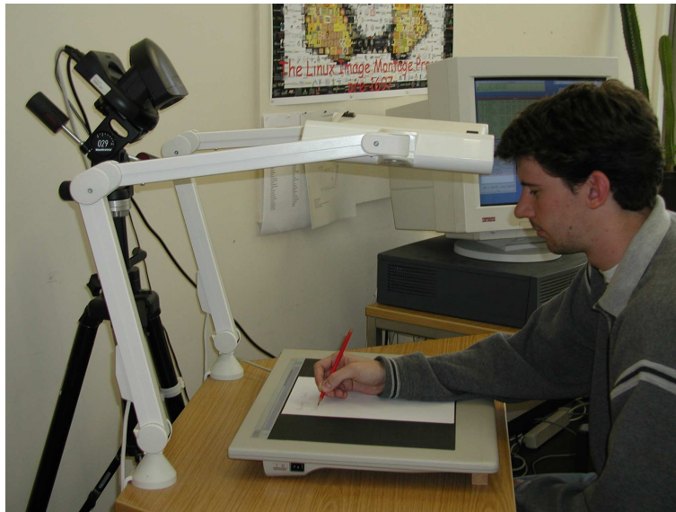
Abbildung 5.1: Systemaufbau zur videobasierten online Handschrifterkennung. Das Digitalisierertablett wird nur zur Fixierung des Papiers und zur Aufnahme von Trainingsdaten eingesetzt.
