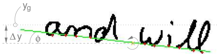
Abbildung 6.7: Konturminima (rot) und Ausgleichsgerade (grün). Außerdem dargestellt: Rotationswinkel \phi und vertikaler Versatz \Delta y zur globalen Basislinie y_g .
