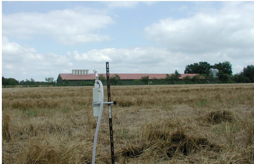
Abb. 2.12: Impinger an einfachem Stativ im Messfeld des Stalles B. Lufteinlass des Impingers in 1,5 m Abstand zum Boden.
