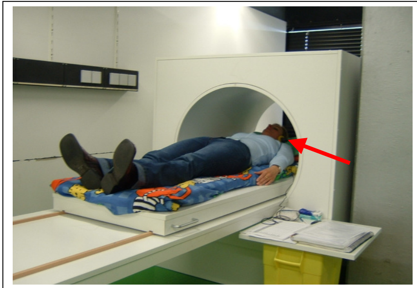
Abbildung 19: Scanner-Simulator in Aachen (der rote Pfeil zeigt den Kopfhörer an, über den die simulierten MRT- Geräusche dargeboten wurden).
