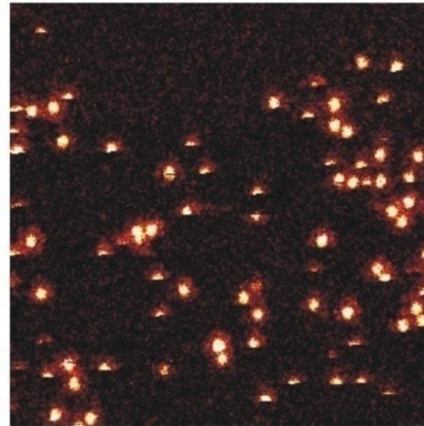
Abbildung 2.5.1: Intensitätsverteilung der Punktabbildungsfunktion eines einzelnen Farbstoffmoleküls [nm]; im rechten Bild sind einzelne Cy5-Moleküle, immobilisiert auf einer Glasoberfläche zu erkennen (Anregung mit 633nm, 14 W/cm 2 ). Das Bild zeigt einen Ausschnitt von 10*10µm.
