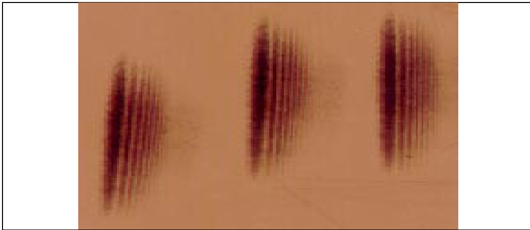
Abbildung 4.4: Drei Strahlprofile des Farbstofflasers auf Fotopapier vor der Frequenzverdopplung.
