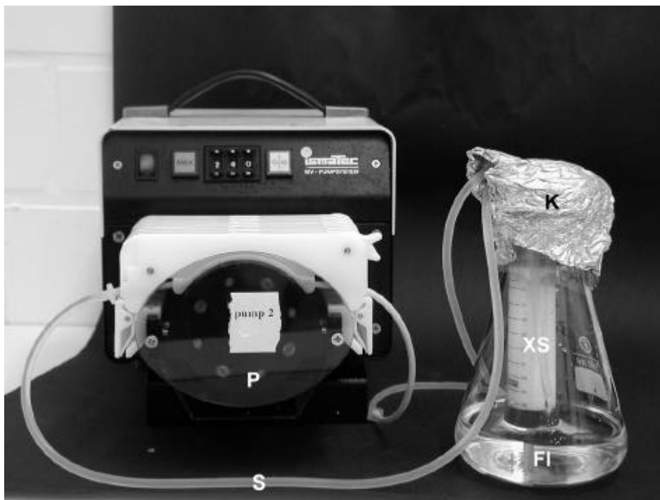
Abbildung 3.4 Versuchsaufbau zur Adsorption von Nod-Faktoren aus Kulturen von Sinorhizobium meliloti Sm1021pEK327 und zur Bestimmung des Adsorptionsverhaltens von Nod-Faktoren an lipophilen Harzkugeln. FI: Flüssigkeit; K: Kolben mit Aluminiumfolie ummantelter Abdeckkappe; P: Schlauchpumpe mit fixiertem Ismapren-Schlauchstück; S: Silikonschlauch und XS: Adsorptionssäule
