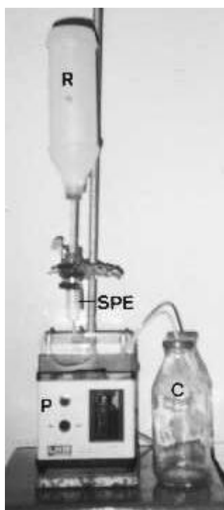
Abbildung 3.8 Versuchsaufbau zur Extraktion von Nod-Faktoren aus ultrafiltrierten Überständen von Satz- und kontinuierlichen Fermentationen mit dem säuretoleranten Bodenbakterium SmLPU63. R: Reservoir mit Belüftungsöffnung; SPE: Festphasenextraktionskartusche; P: Schlauchpumpe; C: Abfallbehälter
