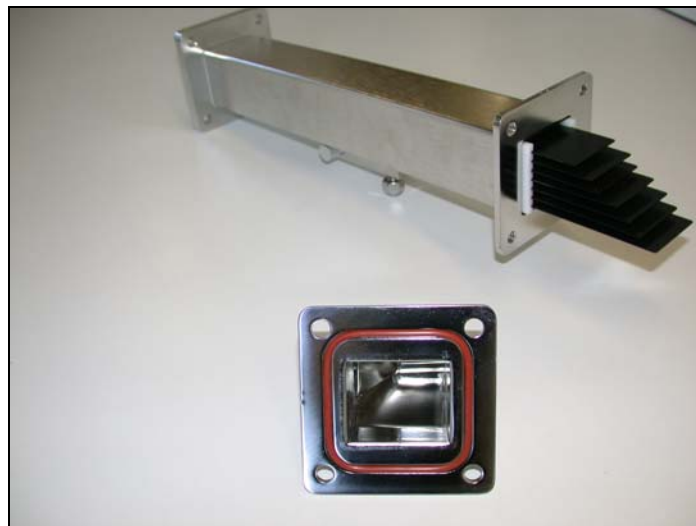
Abbildung 10: CS20.1-Plattensedimenter mit herausgezogenen, teflonbeschichteten Klärböden. Im Vordergrund ist der Bodenkonus abgebildet.
