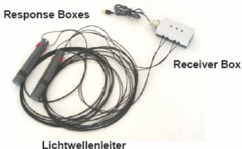
**Abbildung 27: Response-Boxen, Receiver-Box und Lichtwellenleiter**
