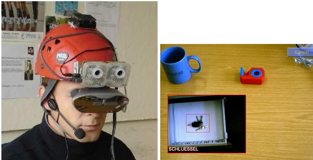
Abbildung 2.1: Links: Benutzer mit dem mobilen System. Das Kamerabild der zwei kleinen am Helm befestigten Kameras wird in das Display eingeblendet und mit Systeminformationen ergänzt. Zur akustischen Kommunikation dienen ein Funkmikrofon und Kopfhörer. Rechts: In den laufenden Videostreams eingeblendete zuletzt wahrgenommene Position des gesuchten Schlüssels in der Schreibtischschublade.
