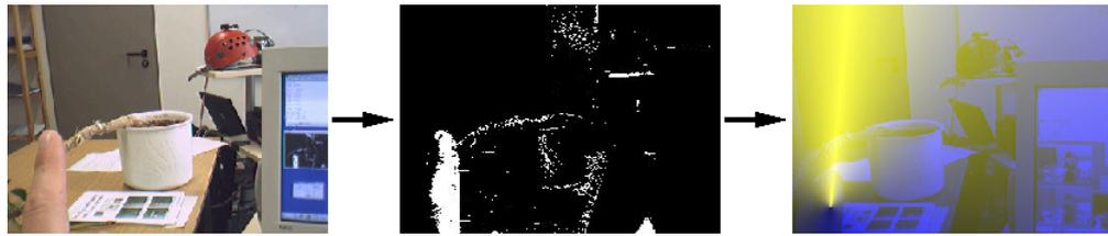
Abbildung 7.1: Zeigegeste auf der mobilen AR-Apparatur. Links: Originalbild. Mitte: Ergebnis der Hautfarbensegmentierung. Rechts: Überlagerung des Kamerabildes mit dem Ergebnis der Zeigegestenerkennung, welche hier allein auf Basis des zeigenden Fingers erkannt wird.
