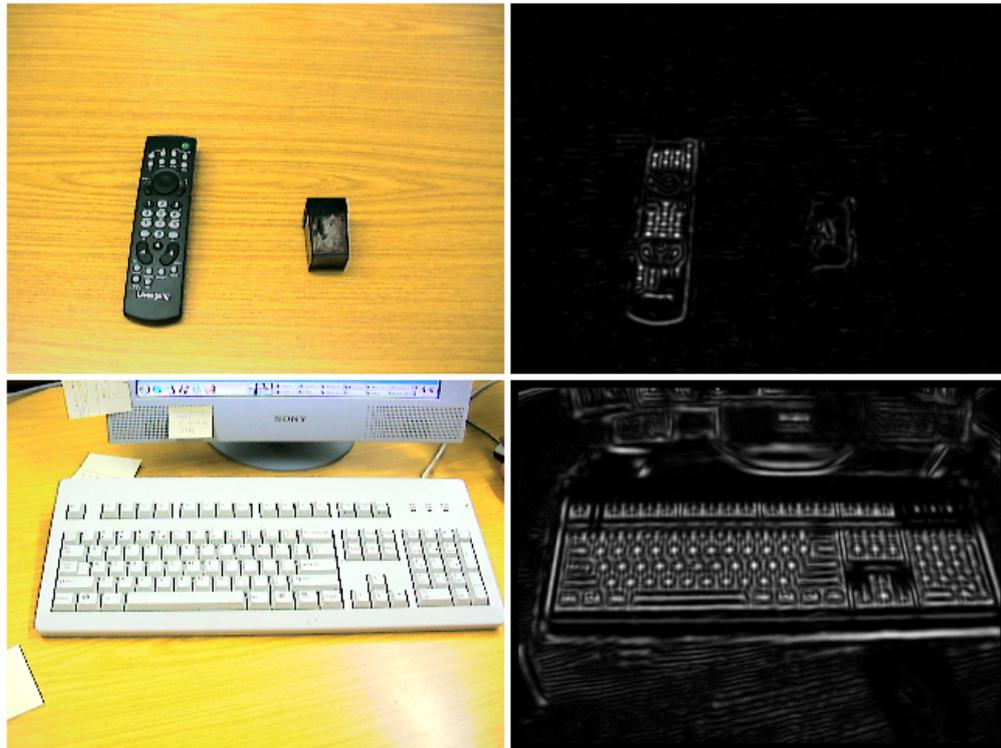
Abbildung 5.3: Domänenanpassung der Symmetriekarten. Die Bilder haben eine Auflösung von  $320 \times 240$ . Ein Symmetrieradius von  $R = 2$  hebt die Knöpfe der Fernbedienung hervor (oben), während die Symmetrie der größeren Objekte ignoriert wird.  $R = 5$  führt zu Symmetriewertmaxima auf den einzelnen Tasten der Tastatur (unten).
