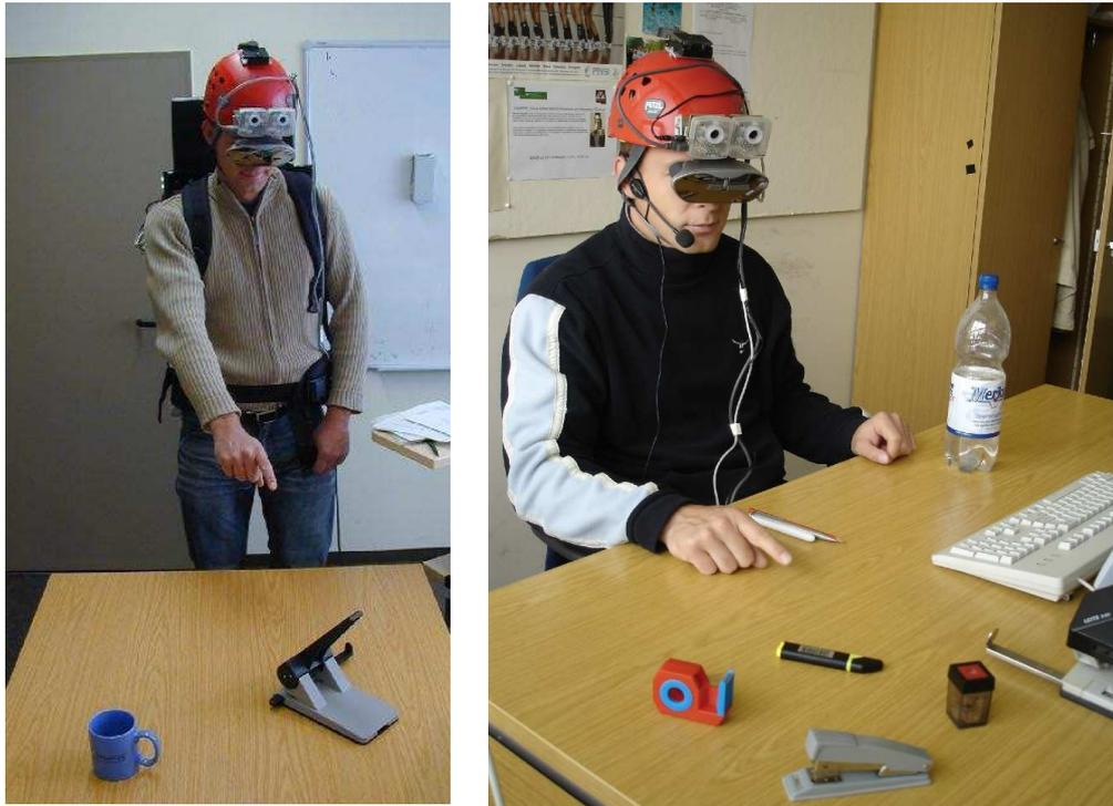
Abbildung 4.2: Benutzer mit dem mobilen System. Das Kamerabild der zwei kleinen am Helm befestigten Kameras wird in das Display eingeblendet und mit Systeminformationen ergänzt.
