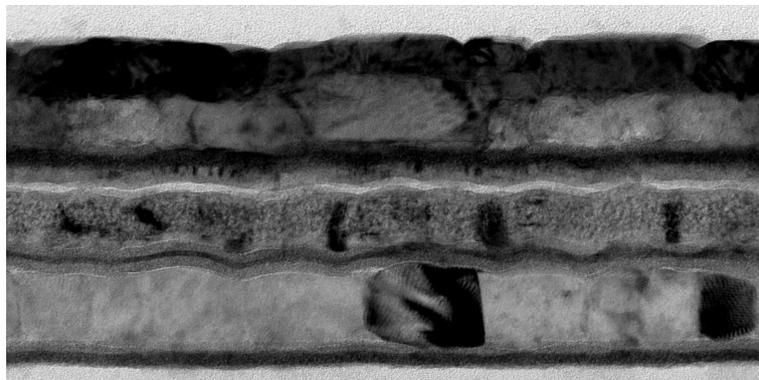
**Abbildung 5.5:** TEM-Bild des gesamten Schichtsystems einer Probe mit einer 1.5 nm dicken AlZr-Barriere, welche einen Zr-Anteil von 6 at.% besitzt.
