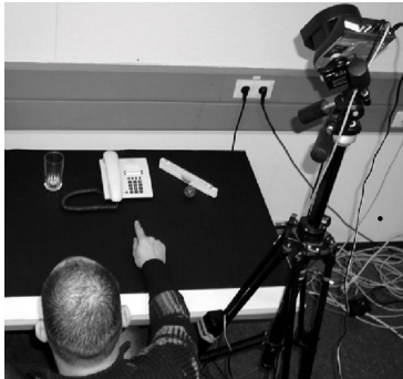
Abbildung 2.9: Das Bild zeigt den Aufbau zur Erkennung der Zeigegeste und Richtung aus der Handstellung. (Bild aus Heidemann u. a. [2004])
