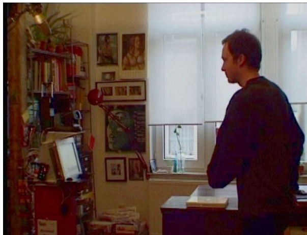
Abbildung 7.1: Während des Experiments in einer Wohnung zeigt eine Person dem Roboter BIRON einen Laptop, der auf dem Tisch im Hintergrund liegt. Aufgrund der Zeigegeste kann der Roboter die referenzierte Region ermitteln und fokussieren. (Bild entnommen aus Wrede u. a. [2006a].)
