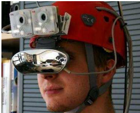
(a) Ein Benutzer trägt eine digitale Brille, in der die Bilder der Kameras angezeigt werden. Die Kameras sind oberhalb der Brille befestigt.
