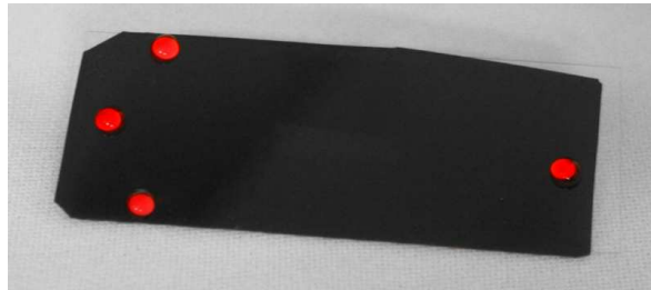
Abbildung 4.12: Ein mit schwarzen Kohlenstoffpigmenten versetzter Mikrofluidik-Chip mit Eosin gefüllten Reservoirs
