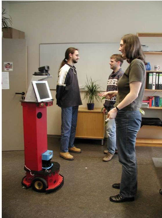
Abbildung 1.1: Bei einem mobilen Roboter kann dem Benutzer kein fester Standort zugeordnet werden. Der Roboter muss aus dem Verhalten der Personen erkennen, wer der Benutzer ist.
