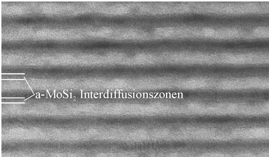
Abb. 6.21. TEM-Aufnahme der Probe PS424, einer Mo/Si-Multischicht mit einer Ag-Barrierschicht an der Grenzfläche Mo-auf-Si ( d_P = 6,87 nm). Auch in diesem Fall bewirkt die Silberschicht eine höhere Grenzflächenrauigkeit. Hinzu kommt, dass die Bildung der Interdiffusionszone an der Grenzfläche Mo-auf-Si nicht verschwunden ist. Offenbar bilden sich, ähnlich wie bei den Ag/Si-Multischichten, keine geschlossenen Ag-Schichten aus, die eine Interdiffusion von Mo und Si verhindern könnten
