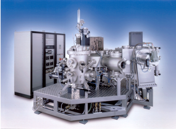
Abb. 3.8. UHV-Beschichtungsanlage, aufgebaut von der Firma Pink Vakuumtechnik (Wertheim) und dem Institut für Werkstofforschung (Dresden) in Zusammenarbeit mit dem FhIWS (Dresden), zur kombinierten Beschichtung mittels MSD und PLD
