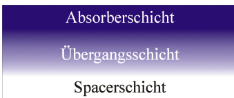
Abb. 2.4. Schematische Darstellung diffuser Grenzflächen in realen Multischichten. Der Übergang von einem Material zum anderen erfolgt nicht abrupt, sondern über einen gewissen Übergangsbereich hinweg, in dem die Konzentrationen beider Schichtmaterialien entgegengesetzt von 0 nach 1 verlaufen
