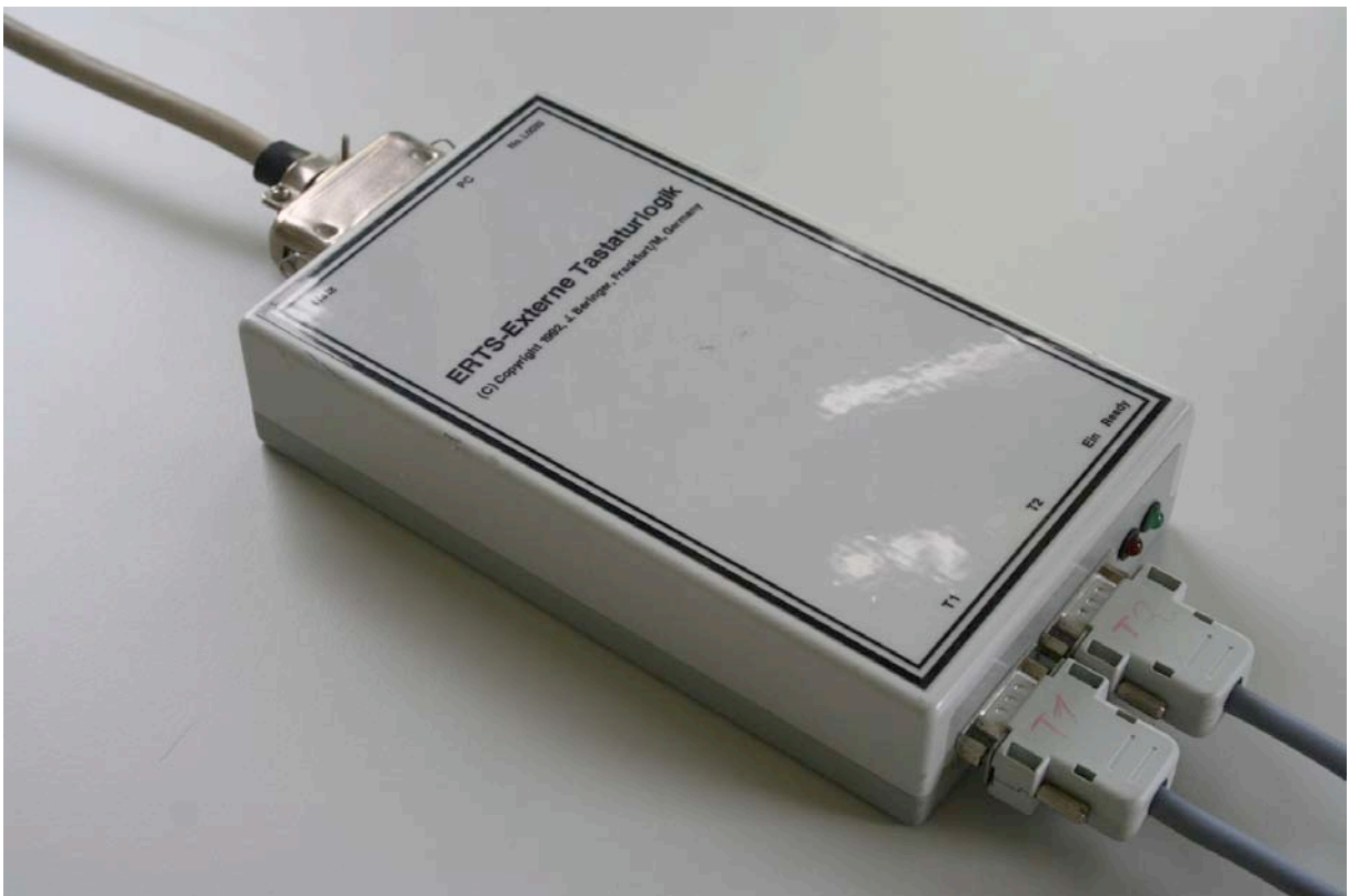
Abbildung 15 Verbindungselement mit Übersetzungsfunktion zwischen Computer und Probandentastatur: Die externe Tastaturlogik des Programms ERTS.
