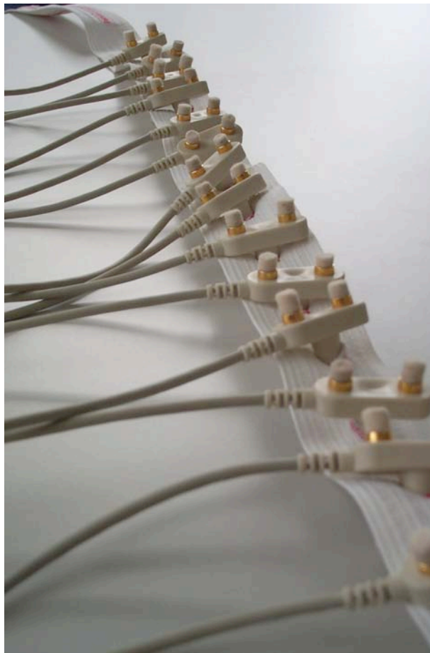
Abbildung 18 In den Gürtel aus Gummilitze wurden die 15 Oberflächenelektroden eingearbeitet, mit nassen Filzeinsätzen bestückt und dann den Probanden angelegt.
