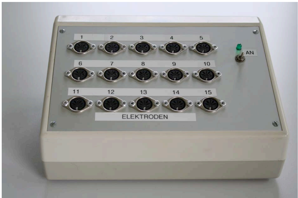
Abbildung 12 Die Relaisstation diente zur Verteilung des vom Konstantstrom-Stimulator erzeugten Reizstroms auf eine von fünfzehn Elektroden.
