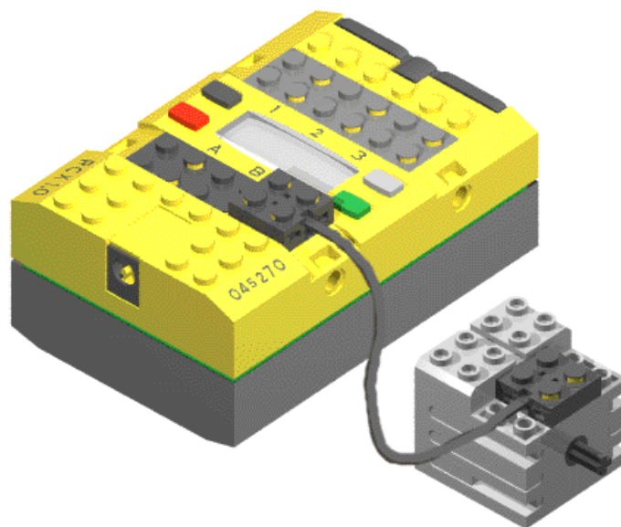
Abbildung 26: Anschließen eines Motors an den RCX mithilfe eines Stromversorgungskabels
