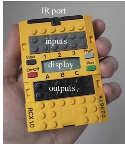
Abbildung 25: Der RCX, das Herzstück des Mindstorm Roboters
