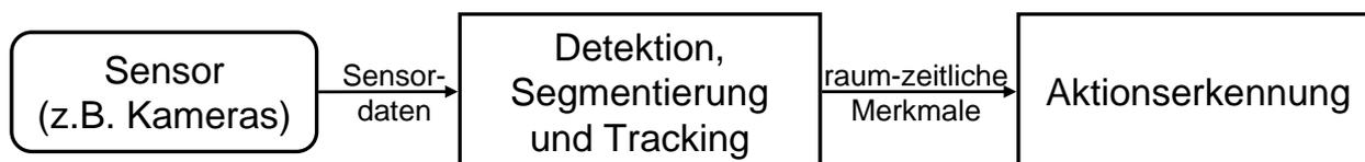
**Abbildung 2.1:** Das Modell eines technischen Systems zur Verfolgung von Objekten und Erkennung von Aktionen.
