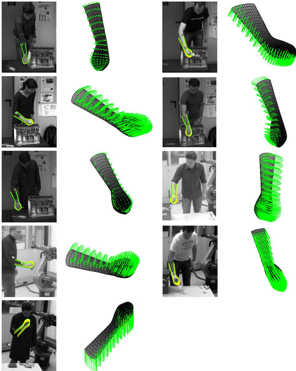
**Abbildung 7.18:** Typische Ergebnisse der raum-zeitlichen Verfolgung des Hand-Unterarm-Bereichs mit System 7.
