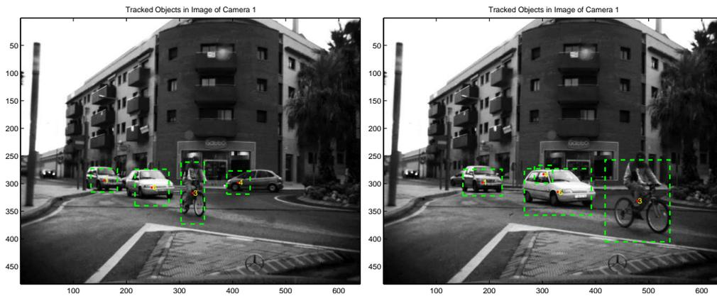
**Abbildung 7.26:** Ergebnisse des ins Bild der Masterkamera projizierten Trackingergebnisses für zwei Zeitschritte. Links: Zeitschritt 97. Rechts: Zeitschritt 113.
