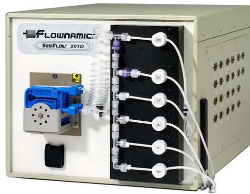
Abbildung 3.8: Probenahmesystem SegFlow (Flownamics). Eine Probe wird mit Hilfe einer peristaltischen Pumpe aus dem Kultivierungssystem gezogen und in ein Schlauchsystem geleitet. Von dort kann sie in bis zu sechs unterschiedliche Einzelvolumina aufgeteilt und weiterprozessiert werden (Flownamics Produktkatalog 2011)
