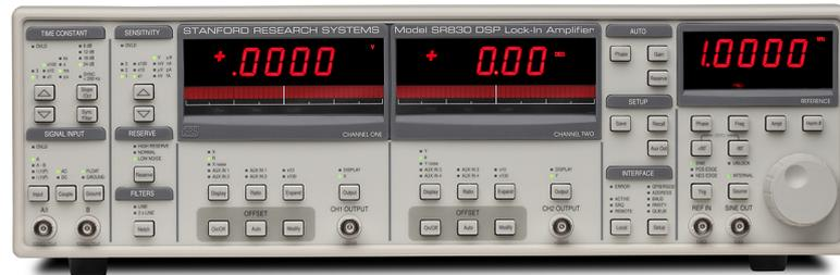
**Abbildung 3.2.2:** Stanford Research Systems Modell SR830 digitaler Lock-In Verstärker [SRS, 2002]
