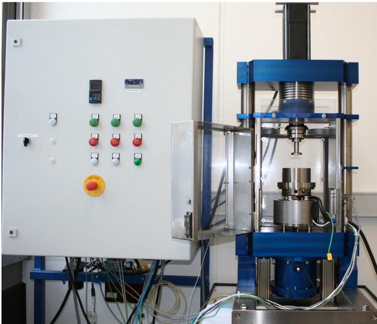
**Abbildung 3.1:** Rotationstribometer RT8000
