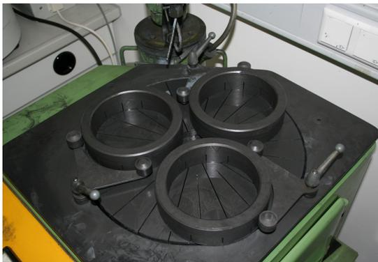
**Abbildung 3.5:** Einscheiben-Läppmaschine
