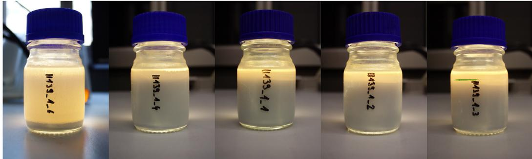
(a) 0 % Pluronic RPE 2520    (b) 0,1 % Pluronic RPE 2520    (c) 0,15 % Plur. RPE 2520    (d) 0,3 % Pluronic RPE 2520    (e) 0,5 % Pluronic RPE 2520
