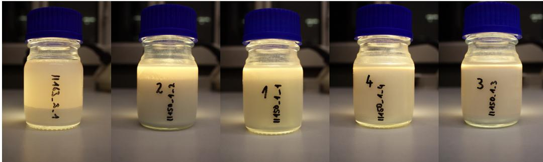
(a) 0% Oleylamin      (b) 0,1% Oleylamin      (c) 0,15% Oleylamin      (d) 0,3% Oleylamin      (e) 0,5% Oleylamin
