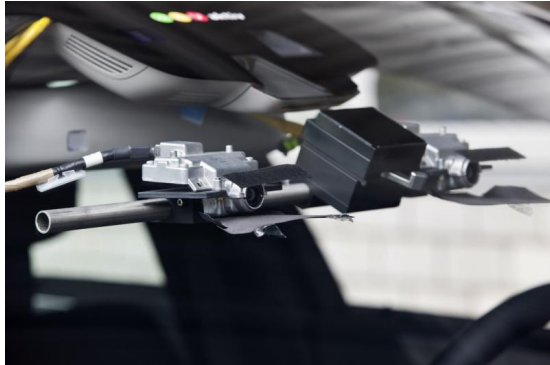
(a) Stereokamera hinter der Windschutzscheibe [17].
