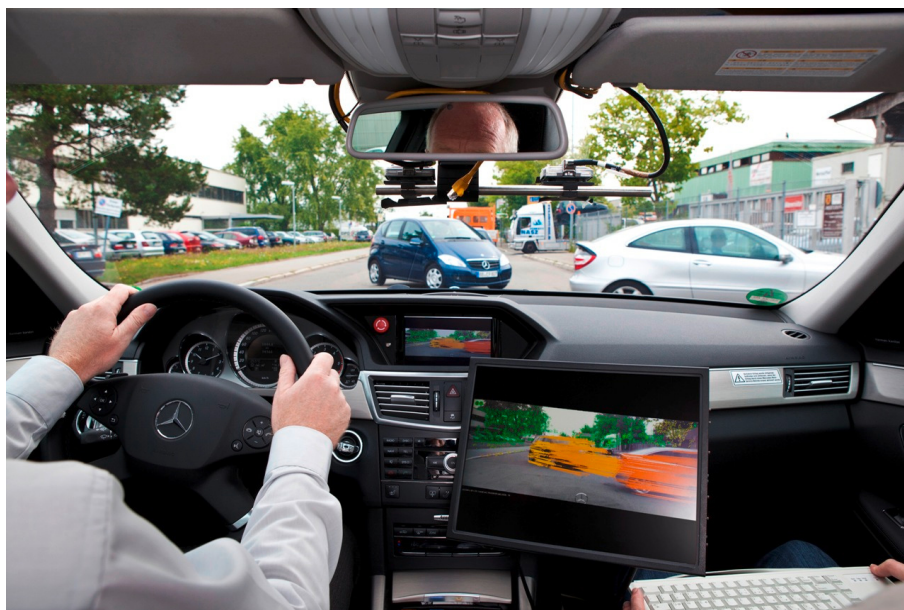
Abbildung 2.3: 6D-Vision auf Basis einer Stereokamera [17].
