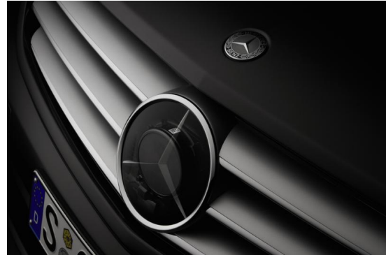
(b) Fernradar hinter der Kühlermaske mit einer Frequenz von 77 Gigahertz und einer Reichweite von 150 m [19].
