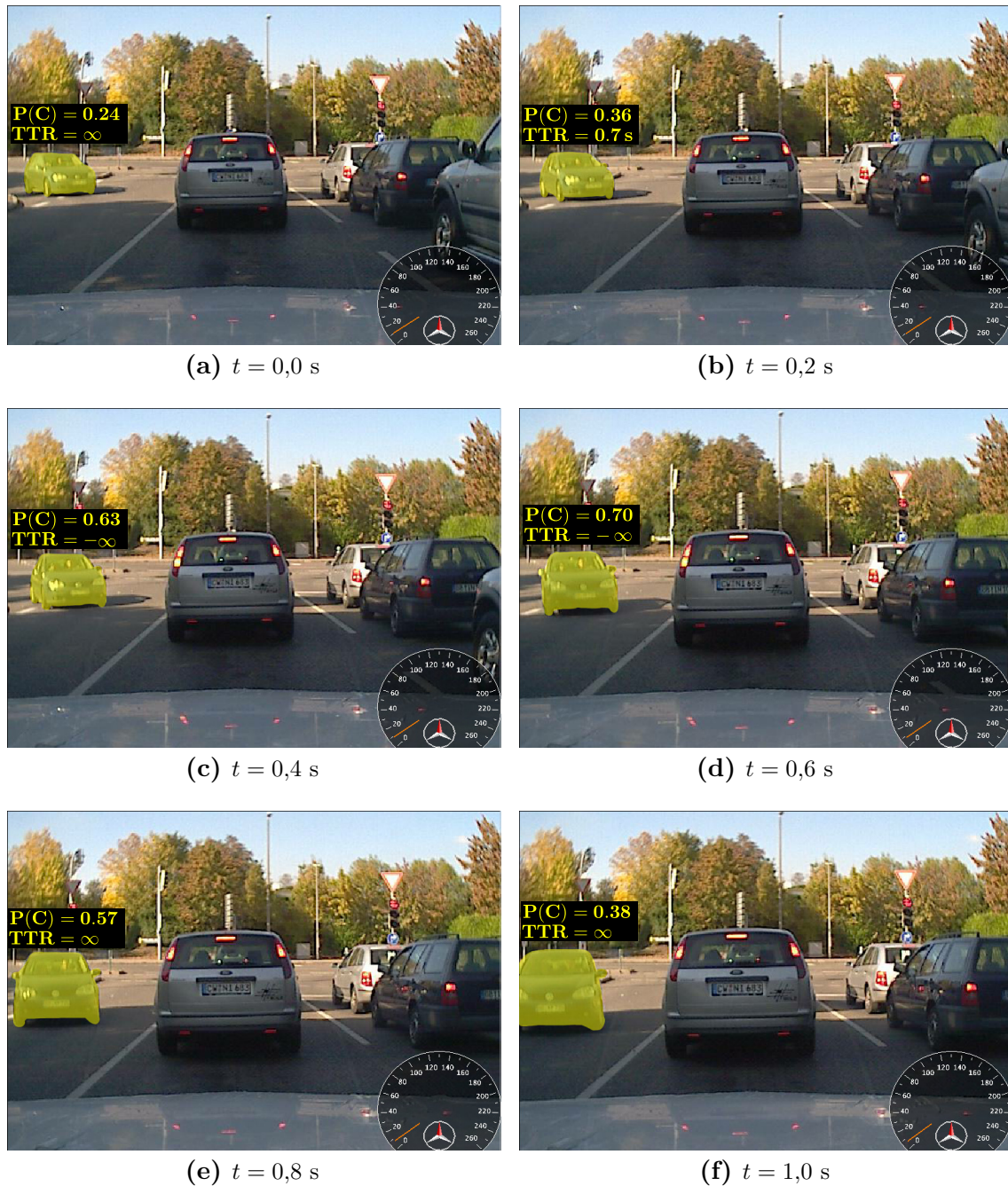
Abbildung 3.14: Vergleich von Zeitreserven (TTR) mit Gefahrenwahrscheinlichkeit ( P(C) ) für ein einbiegendes Fahrzeug (links). Der Zustand des Fahrzeug des Entgegenkommers wird über eine Fusion der Radar- und SMPC-Daten geschätzt [6].
