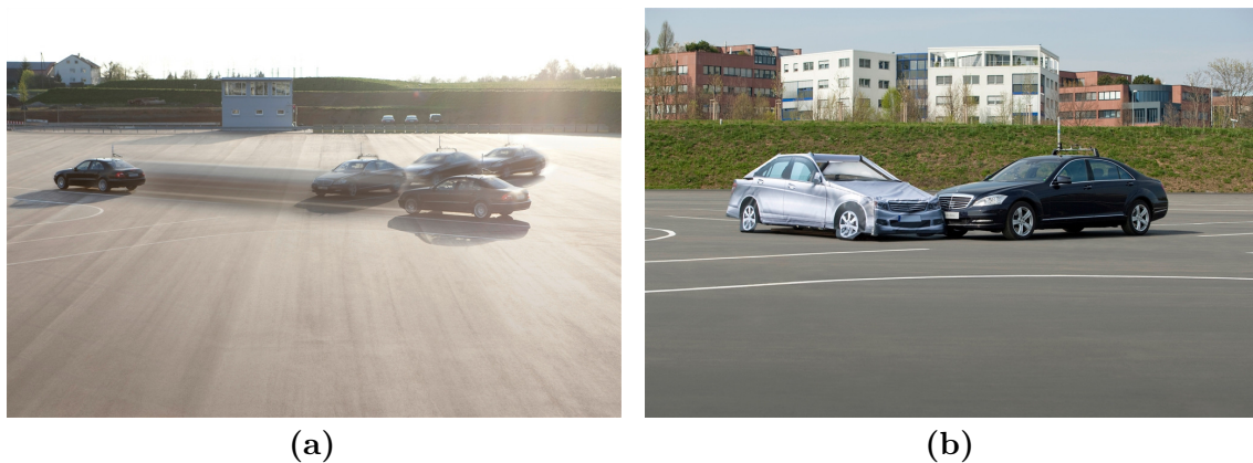
Abbildung 3.9: Daimler-Testgelände für Fahrerassistenzsysteme mit aufgezeichneter Kreuzung(a). Eine Kollision mit dem Softcrash-Target auf einer Testgelände-Kreuzung(b). Copyright Daimler AG
