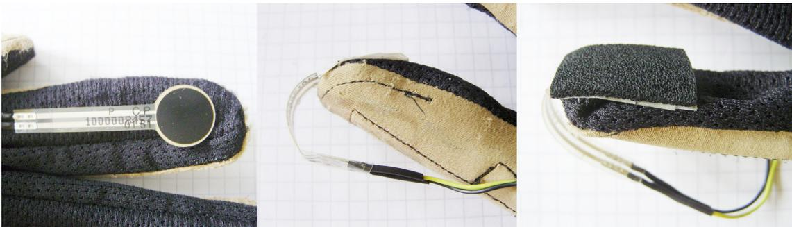
Abbildung 53: Einbindung eines FSR's [GeBü]
