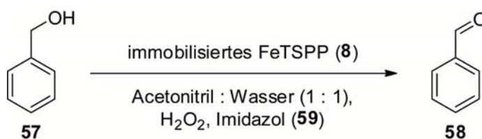
Schema 36. Oxidation von Benzylalkohol 57 in Anwesenheit von FeTSPP ( 8 ), H 2 O 2 und Imidazol ( 59 )
