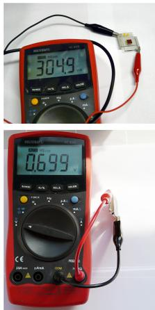
20×20 mm Referenztestzelle (6×6 mm aktive Fläche, rotbraun) einer im AK MATTAY gebauten DSSC mit Ruthenizer 535<sup>®</sup> (in der Lit. als „N719“ bekannt) als Sensibilisatorfarbstoff und einem kommerziellen  $\text{I}_3^-/\text{I}^-$ -Elektrolyt (Iodolyte AN-50<sup>®</sup>) unter Leuchtstoffröhrenbeleuchtung (oben) und unter Sonnenlicht (unten).
