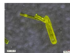
Mikroskopaufnahme eines Kristalls von  $21 \text{ PF}_6^-$  im Auflicht auf einem Aktentordner als Unterlage.
