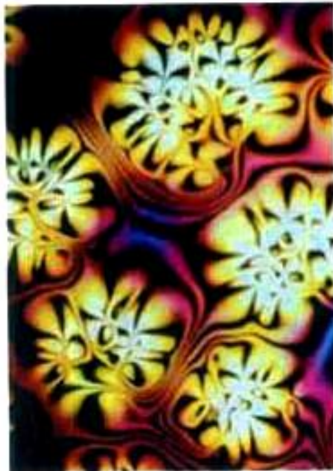
Abbildung 1: Polarisationsmikroskopische Aufnahme eines dünnen Films einer nematischen Schicht eines Flüssigkristalls auf einem isotropen Substrat [1].
