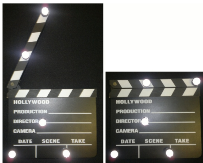
Abbildung 26 Motion-Capture-Video-Synchronisationsklappe (a) offen (b) zugeklappt Markerklappe, die in dieser Anordnung einen Rigidbody definiert.
