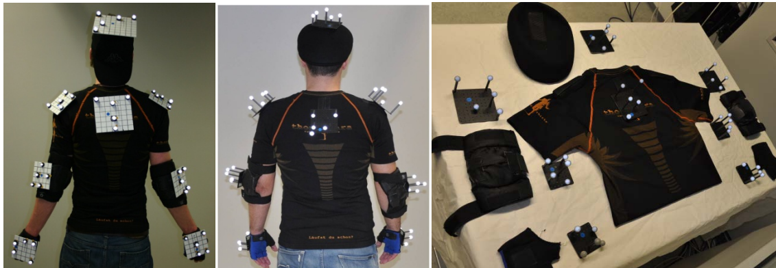
Abbildung 24 (a) Positionierung der alten 2D Rigidbodies am Körper (b) überarbeitete 3D-Rigidbodies am Körper (c) Rigidbodies mit T-Shirt, Handschuhen, Ellenbogenbefestigung und Hut (wurde ersetzt durch Haarreifen)
