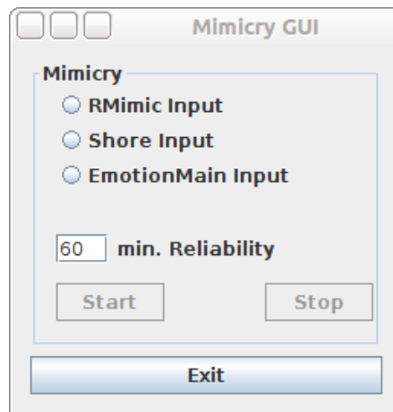
Abbildung 5.7: In dieser Abbildung ist das Benutzerinterface der ersten Ebene dargestellt. In dieser GUI wird ausgewählt, welche Quelle als Eingabe für das System dient. Des Weiteren wird die Komponente hierüber gestartet und gestoppt.
