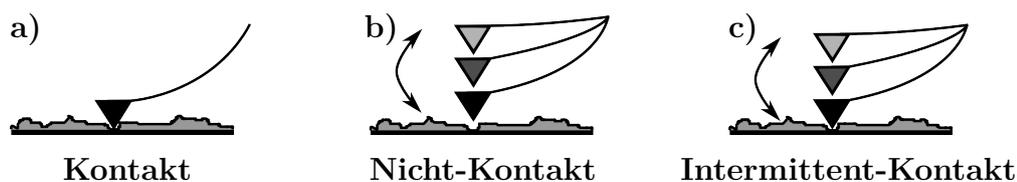
**Abbildung 2.22.:** Schematische Darstellung der unterschiedlichen Modi bei der Rasterkraftmikroskopie. **a)** Kontakt-Modus, **b)** Nicht-Kontakt-Modus, **c)** Intermittent-Kontakt-Modus (engl. *tapping mode*).
