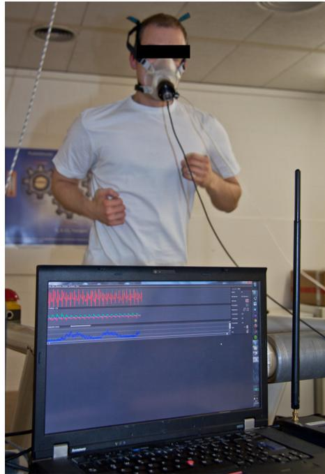
Abbildung 3.3.: Proband während der Ergospirometrie. Zusätzliche Erfassung der Thoraxerweiterung und -verengung mit dem Atemsensor des BG-V4.2; der gemessene Kraftverlauf ist im Signalmonitor blau visualisiert.
