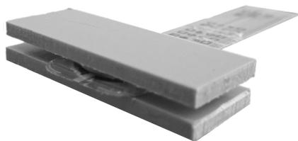
(d) Prototyp gefertigt mit einer CNC-Fräse.
