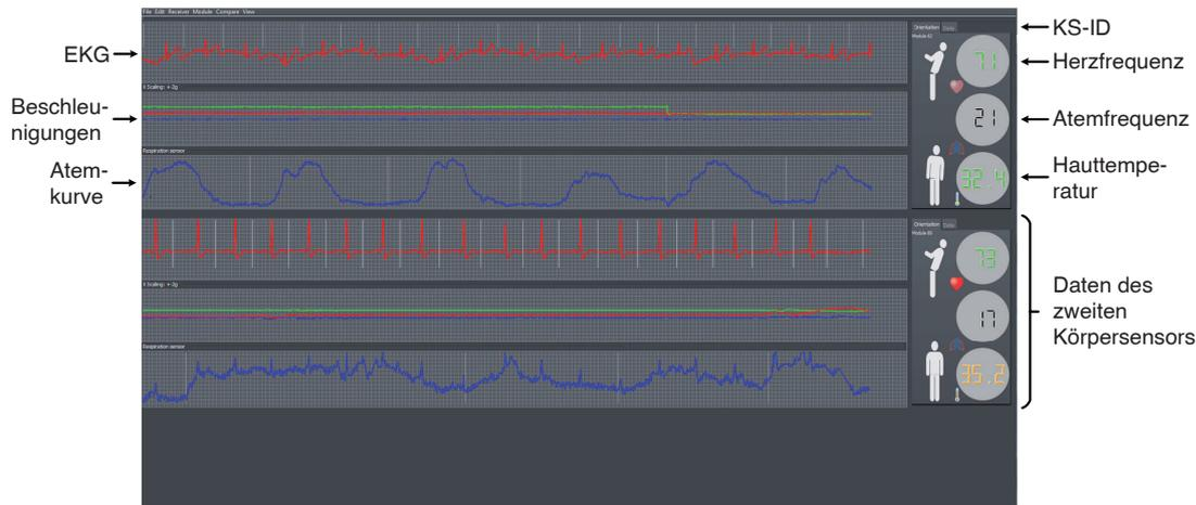
Abbildung 2.5.: Signalmonitor zur Online-Darstellung von Sensormesswerten und Parametern.
