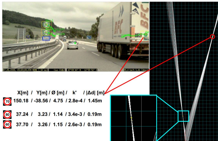
Abbildung 1.4.: Das System zur Verkehrszeichenerkennung nach [Lindner, 2012] berechnet zusätzlich zur Bedeutung die Position, die Größe und die Entfernung der Verkehrszeichen zur Kamera anhand einer Triangulierung. Bildquelle: [Lindner, 2012, S. 122]
