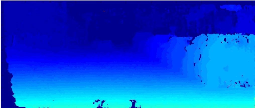
Abbildung 1.14.: Das Semi-Global-Matching(SGM) bestimmt für zwei gegebene Bilder einer Szene, die von unterschiedlichen Positionen zum gleichen Zeitpunkt aufgenommen wurden, die Korrespondenzen. Dieses Bild beschreibt einen Raum, der in [Hirschmüller, 2008] definiert und bestimmt wird. Die Größe der Disparität zweier miteinander korrespondierender Punkte ist farblich kodiert. Cyan sind kleine Disparitäten in einem Nahbereich im Sichtbereich und blau sind die Disparitäten in weiter Entfernung im Sichtbereich der Kamera.
