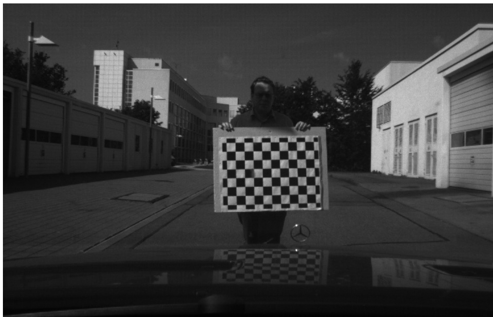
Abbildung 3.3.: Wenn eine Kamera auf ein Schachbrett ausgerichtet wird und ein weiteres Schachbrett zur intrinsischen Parameterbestimmung eingesetzt wird, kann die extrinsische Position sehr genau ermittelt werden. Durch die kurze Distanz zur Kamera kann die Kalibrierung im Nahbereich exakt bestimmt werden.
