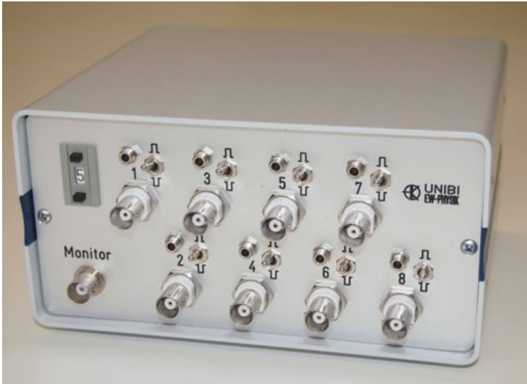
Abbildung 60: Messbox zum Digitalisieren von Neuronensignalen. Bei den acht Eingängen kann jeweils der Grenzwert sowie die Richtung festgelegt werden, in der der Grenzwert überschritten werden muss. Über den Monitor -Ausgang kann das Signal für einen ausgewählten Eingang direkt ausgelesen werden.
