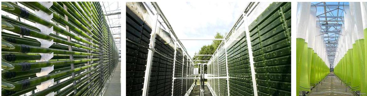
**Abbildung 4:** Geschlossene Photobioreaktorsysteme deutscher Firmen. **Links:** tubuläre Systeme aus Borosilikatglas von der Firma IGV/bbi-biotech GmbH (Nuthetal/Berlin, BRD). **Mitte:** Flachplattenreaktoren aus Tiefziehplastik von Subitec mit 180 L-Modulen und einer illuminierbaren Fläche von rund 5 m<sup>3</sup> je Seite (Stuttgart, BRD). **Rechts:** Folienschlauchreaktoren von Novagreen mit 4,6 m<sup>3</sup> je Standardmodul (Vechta-Langförden, BRD).
