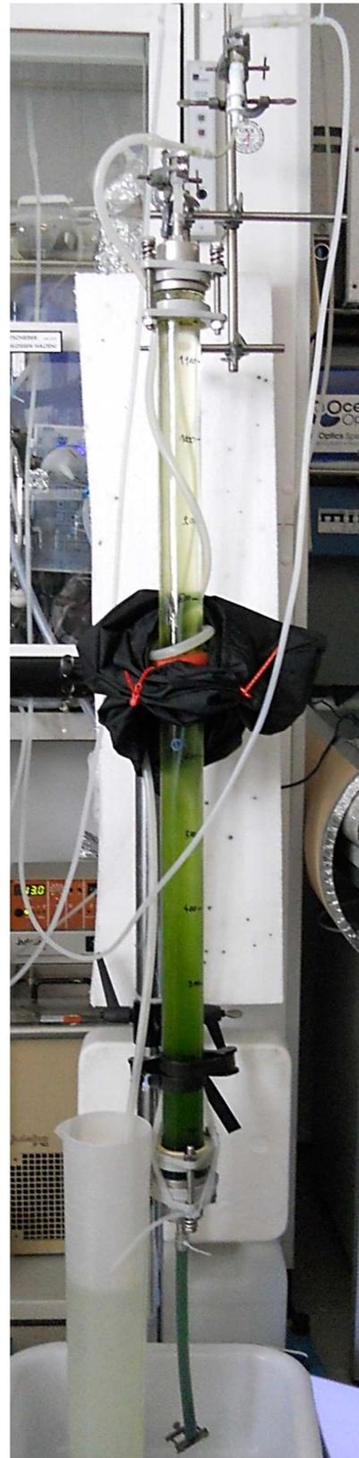
**Abbildung 88:** Betrieb einer Sedimentationssäule mit Kulturbrühe aus einer kontinuierlichen Kultivierung mit *E. gracilis*.
