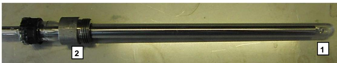
**Abbildung 22:** Photodiode in einem Borosilikatglasrohr (Durchmesser 12 mm) für den Einbau über einen Stutzen. Die Diode (1) wird im Glasrohr mit Hilfe eines Stahlrohrs auf der richtigen Höhe gehalten und ist damit zentral im Reaktor positioniert. Das Glasrohr wird über ein Stutzen in den Reaktor eingeführt und mit einer Tülle aus Edelstahl (2) fest verschraubt, wobei der konische Teflonring und eine entsprechende Dichtung hierzu nicht abgebildet sind.
