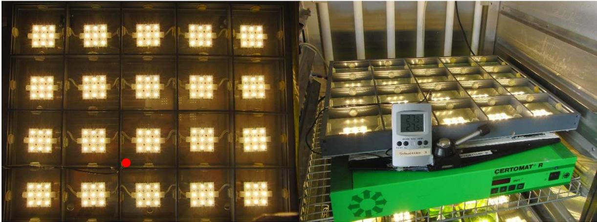
**Abbildung 14:** Konstruierter Illuminationsaufsatz mit ansteuerbaren SMD-LED Beleuchtung. **Links:** Aufsicht der 20 Stellplätze. **Rechts:** Installation auf einem Orbitalschüttler und separatem Thermometer mit externem Sensor (roter Punkt) auf der Glas- bzw. Stellfläche.
