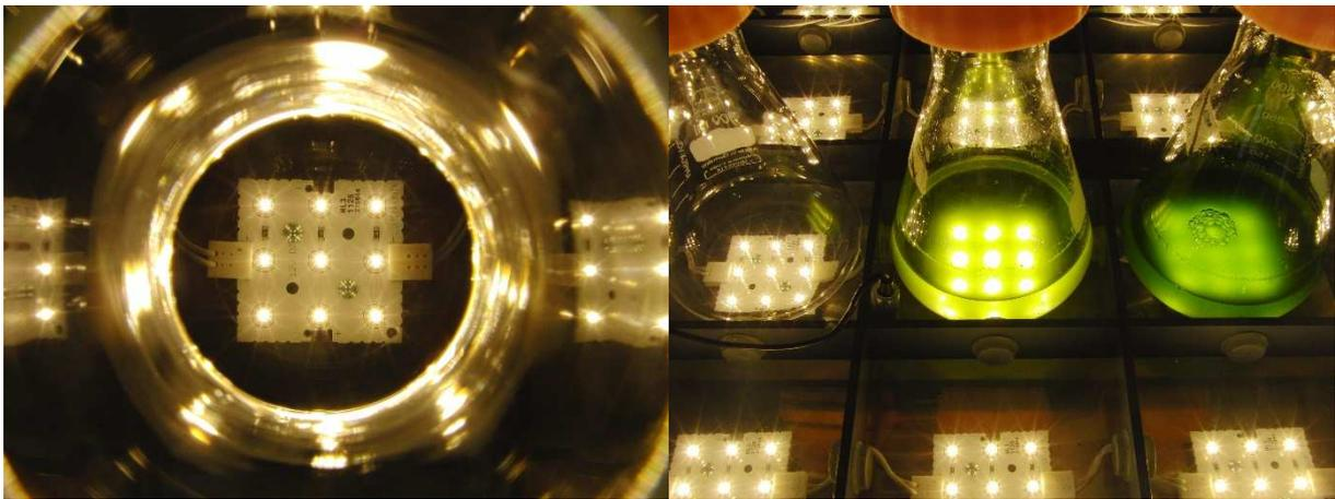
**Abbildung 15:** Konstruierter Illuminationsaufsatz mit ansteuerbaren SMD-LED Beleuchtung im Detail. **Links:** Aufsicht in einen illuminierten Schüttelkolben. **Rechts:** Leerkolben und Kulturen mit unterschiedlichem Kulturalter.
