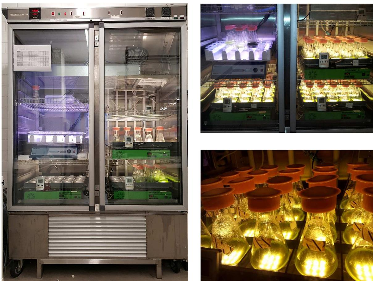
**Abbildung 17 links:** Modifizierter Brutschrank mit eingebauten CO<sub>2</sub>- und Temperaturregelung, zusätzlicher Kühlung und über eine Fernbedienung regulierbaren und statischen Stromstärkequellen (12 V) für die LED-Illuminationsaufsätze. **Rechts:** Parallelkultivierung von 60 Schüttelkolben auf 3 LED Illuminationsschüttlern und zum Vergleich einem Vorgängermodell mit Leuchtstoffröhren.
