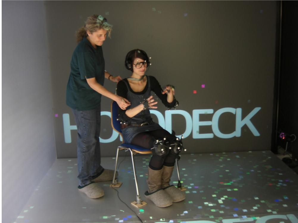
**Abbildung 12:** Bewegungserfassung per Motion-Tracking. Die Infrarotkameras des Systems erfassen Bewegungen über reflektierende Marker (weiße Kügelchen in der Abb.), die je nach Bedarf an verschiedenen Körperpartien angebracht werden können, sowie aktive Infrarot-Leuchtdioden. So können detaillierte Informationen bezüglich der Bewegungsausführung gespeichert werden (Müller 2013, S. 101).
