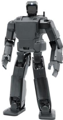
Das ist der Roboter, der in der Vorstellungsaufgabe vorkommen wird. Es ist ein interaktiver Roboter, der sich eigenständig bewegen und auf mündliche Anweisungen reagieren, sowie selbst Sprache produzieren kann. Der Roboter kann Objekte erkennen, finden, greifen und sie an ihren Bestimmungsort bringen. Er ist in der Lage, Personen zu erkennen und mit Namen zu benennen. Er kann Hindernissen ausweichen und sich schnell räumlich orientieren.
