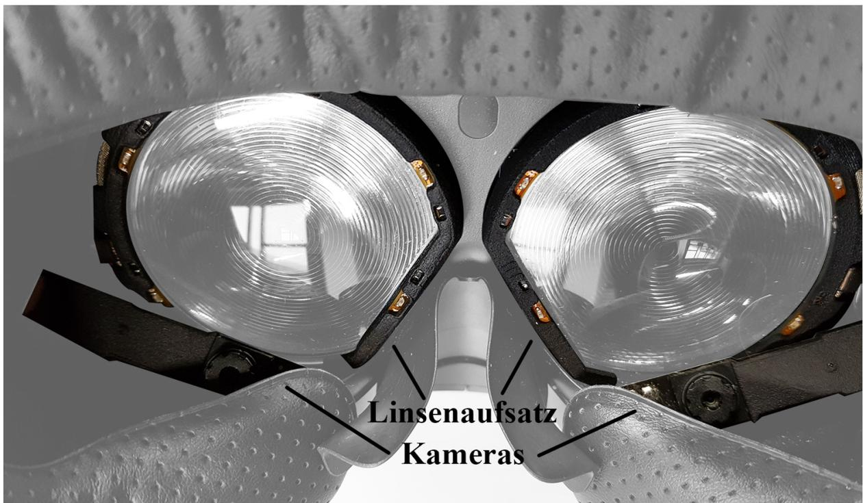
Abbildung 1: Der Aufsatz von Pupil Labs für die Vive, angebracht an die Linsen.
