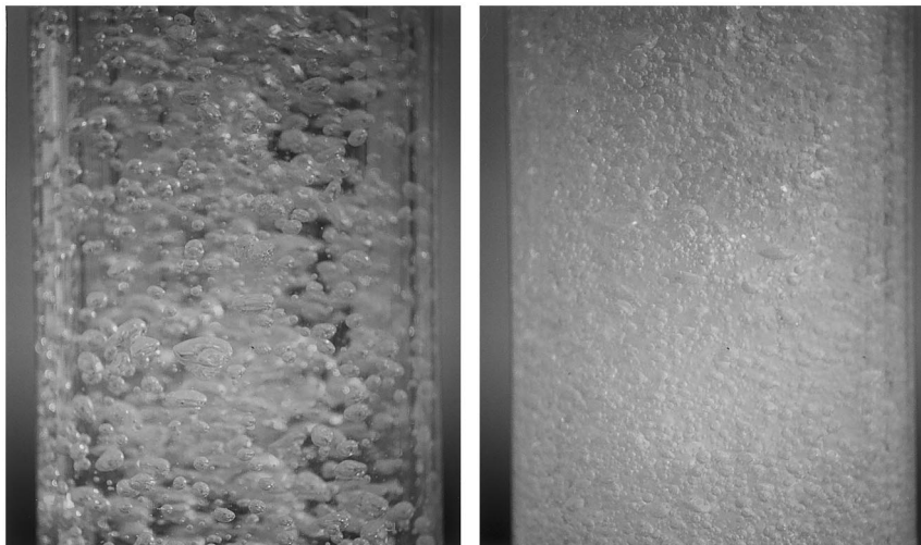
Abbildung 3.9: Blasenverteilung in Meerwasser bei Begasung mit 154 (links) und 518 \text{ W/m}^3 (rechts) [137]. Bei 154 \text{ W/m}^3 ist Lichttransmission möglich, während bei 518 \text{ W/m}^3 die Trübung durch die feine Verteilung der Blasen Licht abblockt.
