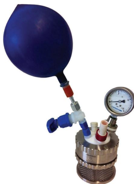
Abbildung 2.7: Foto des verwendeten 100 mL-Tischreaktors von *Büchi* zur Durchführung von Reaktionen mit einem Druck von bis zu 10 bar. Zur Veranschaulichung des Versuchsaufbaus wurde ein mit Luft gefüllter Ballon auf den Zulauf des leeren Reaktors gesetzt.
