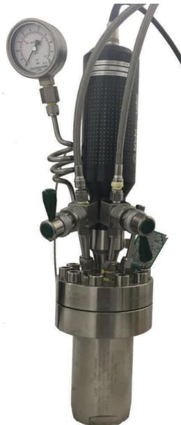
Abbildung 2.12: Foto des verwendeten 285 mL-Stahlreaktors von *Büchi* zur Durchführung von Reaktionen mit einem Druck von bis zu 200 bar.
